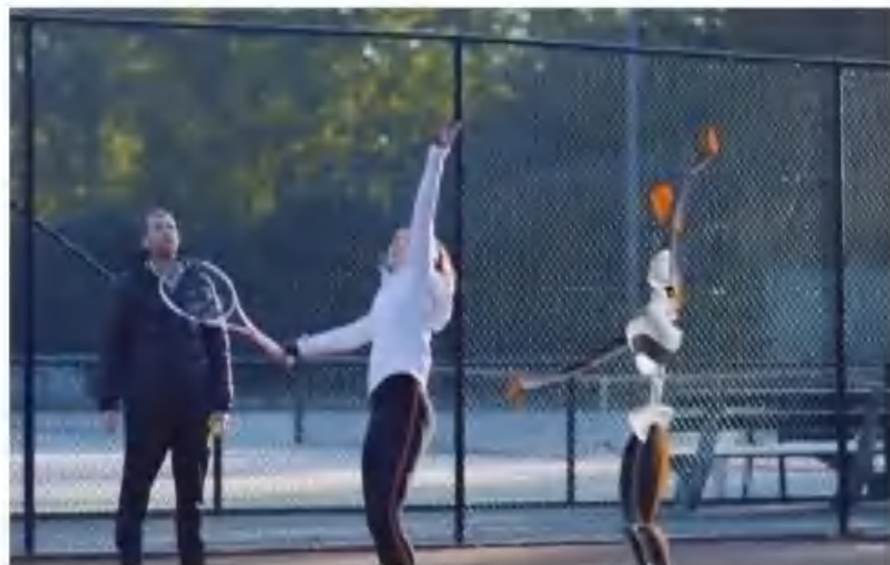
图：动捕数据驱动人形机器人学会“像人一样运动”
